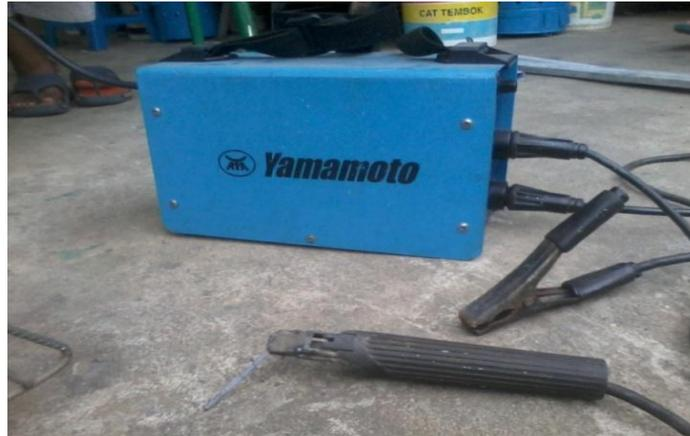
**Gambar.4.** Mesin Las Untuk Pengelasan Specime
