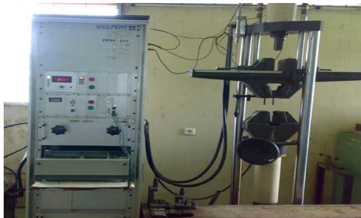
**Gambar 5.** Mesin Uji Tarik
