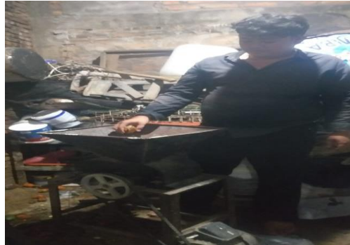
Gambar 5. proses memasukkan pinang ke hopper
